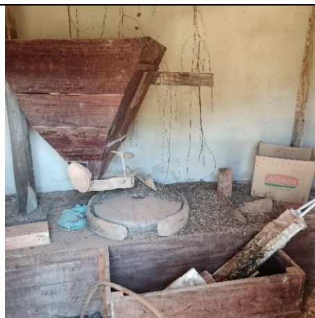
Foto 8: Vista geral do interior do abrigo do moinho, com a moega de madeira e o sistema de moagem rústico, apresentando partes do sistema desmontado. Alex Alves Pereira, 22 jul. 2025.
