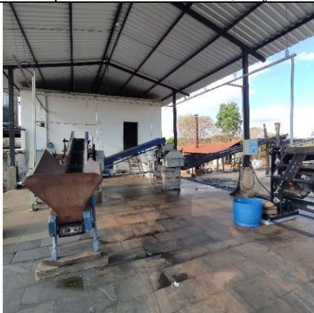
Figura 6: Vista da linha de moagem e processamento, mostrando as esteiras e a área de prensagem da cana. Alex Alves Pereira, 22 jul. 2025.
