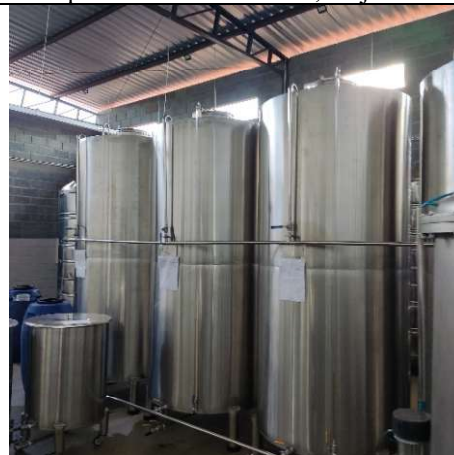
Figura 11: Tanques de aço inoxidável para armazenamento do destilado antes de serem envelhecidos e envasados. Alex Alves Pereira, 22 jul. 2025.
