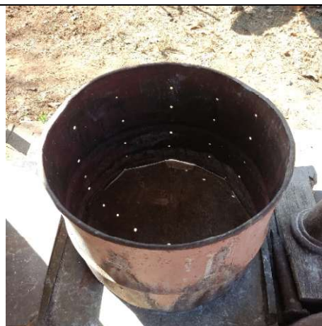
Figura 9: Tambor metálico perfurado utilizado para a prensagem da massa de mandioca. Alex Alves Pereira, 22 jul. 2025.
