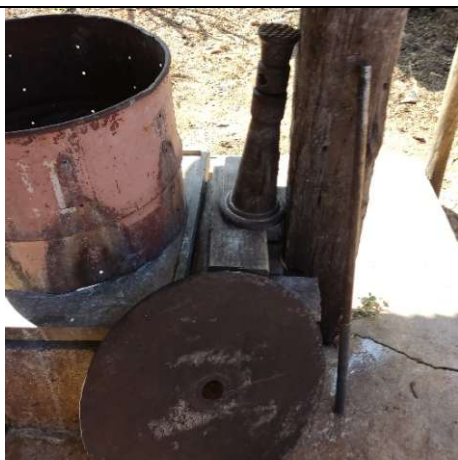
Figura 8: Detalhe da prensa com tambor furado para escoamento do líquido e parte do sistema de pressão. Alex Alves Pereira, 22 jul. 2025.
