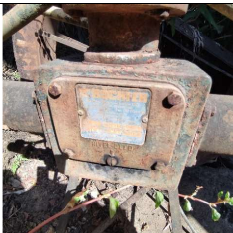
Foto 7: Detalhe da placa de identificação do mecanismo instalado no sistema de acionamento do moinho, em estado de abandono. Alex Alves Pereira, 22 jul. 2025.
