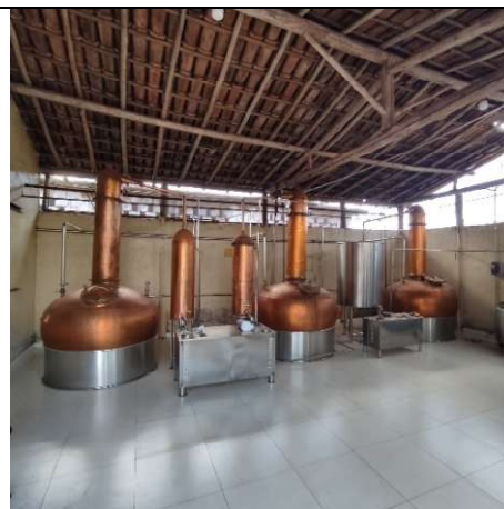
Figura 9: Vista dos alambiques de cobre, essenciais para o método de destilação tradicional da cachaça de alambique. Alex Alves Pereira, 22 jul. 2025.
