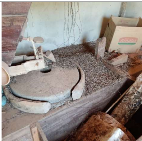
Foto 9: Vista do maquinário interno do moinho, mostrando o funil de madeira e a pedra de moagem em estado de desativação. Alex Alves Pereira, 22 jul. 2025.
