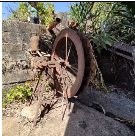
Foto 6: Detalhe da peça metálica da antiga roda d'água, em avançado estado de oxidação e coberta por vegetação, próxima ao abrigo. Alex Alves Pereira, 22 jul. 2025.
